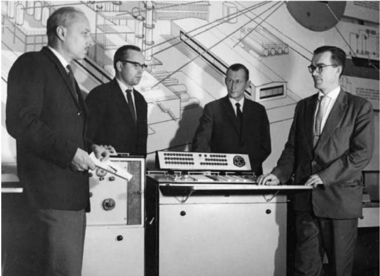
Управляюча машина широкого призначення "Дніпро". Київ, 1960 рік
